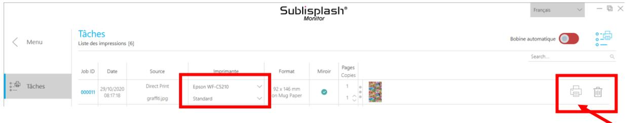
Dans la section « Imprimante », vous pouvez maintenant modifier l'imprimante et / ou le profil d'impression. Vous pouvez supprimer le travail d'impression à réaliser en cliquant sur l'icône « Corbeille ».
