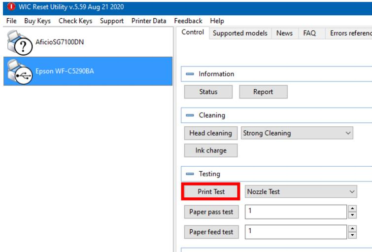
Cliquez sur «Print Test» pour imprimer un test des buses.
