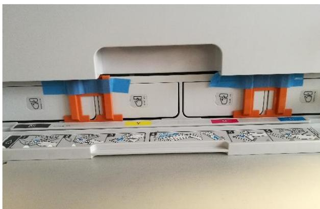
L'étape suivante consiste à remplir les cartouches vides fournies. Lors du remplissage des cartouches, il est important de remplir la bonne couleur d'encre dans **la cartouche** de couleur correspondante ! Les cartouches vides sont marquées d'un autocollant indiquant la couleur à utiliser.
