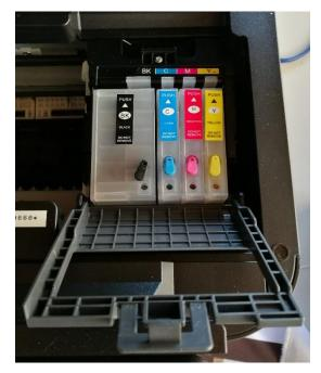
Der Druckkopf fährt in eine Position an der Du die Tintenpatronenabdeckung öffnen kannst.
