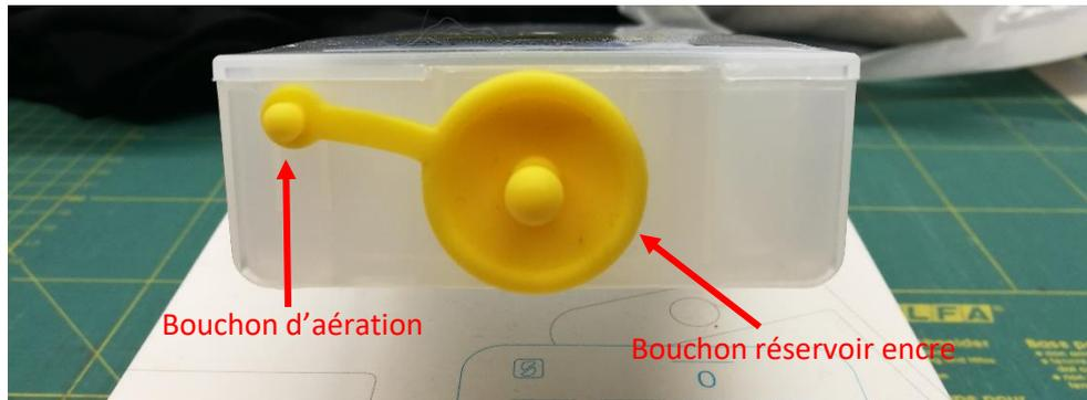
Pour permettre à l'air de s'échapper et à l'encre de circuler, tenez la cartouche à la verticale après le remplissage (avec le bouchon d'aération toujours retiré) et secouez doucement une dizaine de fois. Ensuite, laissez la cartouche à la verticale pendant environ 5 minutes.
