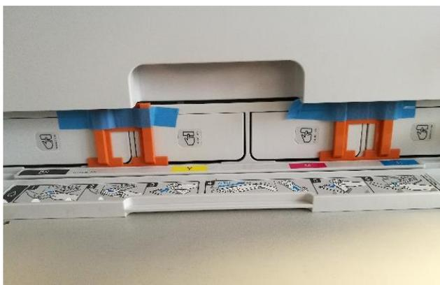
L'étape suivante consiste à remplir les cartouches vides fournies. Lors du remplissage des cartouches, il est important de remplir la bonne couleur d'encre dans la cartouche de couleur correspondante! Les cartouches vides sont marquées d'un autocollant indiquant la couleur à utiliser. A chaque couleur correspond une lettre :
