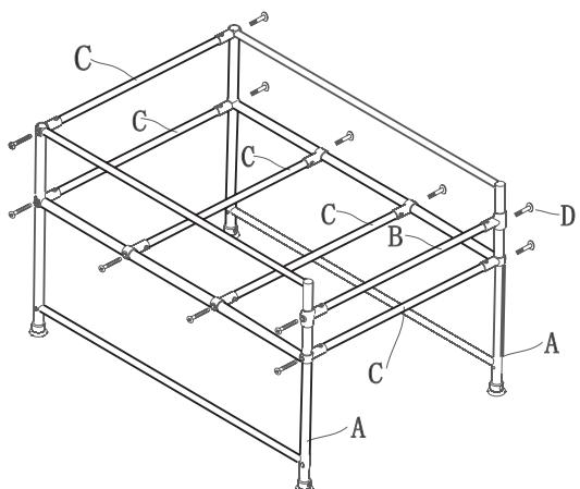
Alinee la barra conectora B entre los paneles A en el lado superior derecho corto según la figura. Enganche a presión y fíjela con tornillos.
