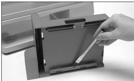
Figura 6. Cómo lubricar las guías del carro transportador de alimentos.
