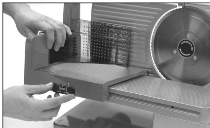
Figura 5. Cómo retirar el carro transportador de alimentos.
