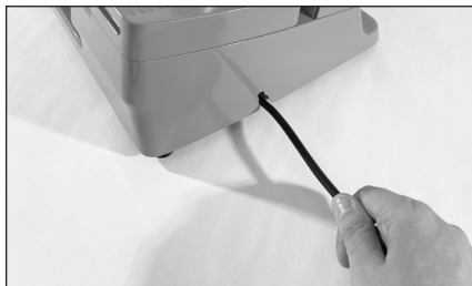
Figura 3. Meter el cable en exceso dentro del compartamiento correspondiente.
