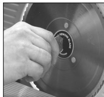
Figure 7. Tournez la vis dans le sens des aiguilles d'une montre pour retirer la lame.
