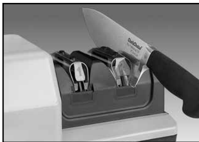
Малюнок 7. Доводка на Етапі 2 - Чергуйте протяжки в лівому і в правому пазах, щоб створити остаточну грань. Лезо ножа злегка торкається Стопорної пластини.
