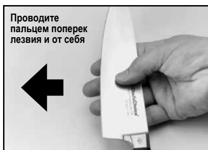
Рисунок 5. Заусенец можно определить, проведя пальцами поперек лезвия и от себя. Осторожно! См. текст.
