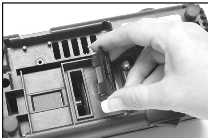
Figura 14. Quitar la cubierta debajo de la base para limpiar las limaduras de metal (Consultar la sección Mantenimiento Normal).
