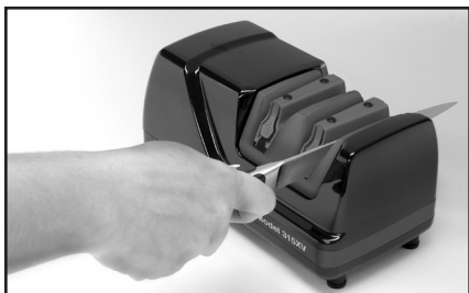
Figura 8. Hoja de corte europea en la ranura derecha, Etapa 2.
