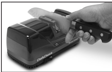
Figure 13. Insérez votre index comme illustré derrière l'entablure à mesure que le couteau est inséré dans la fente d'affûtage (voir la suggestion 8).
