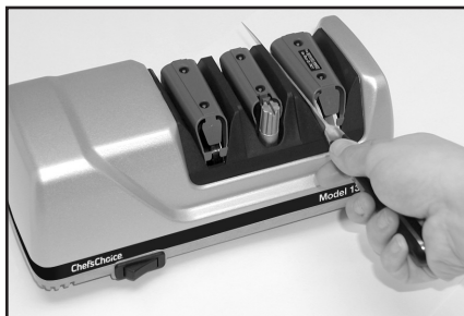
Figura 6. Introducción de la hoja en la ranura de la izquierda de la Etapa 3. Movimientos alternos entre las ranuras de la derecha y la izquierda.
