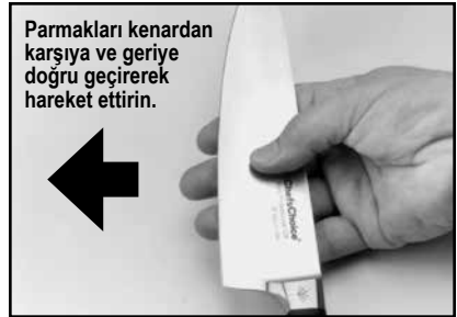
Şekil 5. Çapak, parmakları ağızdan karşıya ve geriye doğru kaydırarak kontrol edilebilir. Dikkat! Yandaki açıklamaya bakın.
