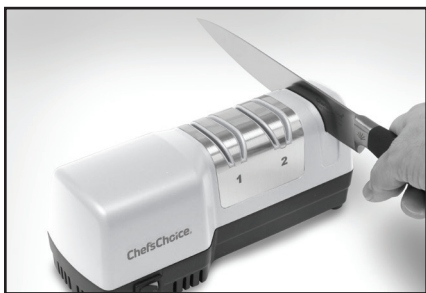
Figura 6. Cuchillo en la etapa 3. Realice pasadas de afilado hacia adelante y hacia atrás y ejerza una presión leve. Lea el texto.
