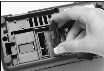
Abbildung 10. Reinigen Sie die Abdeckung unter dem Schärfgerät.
