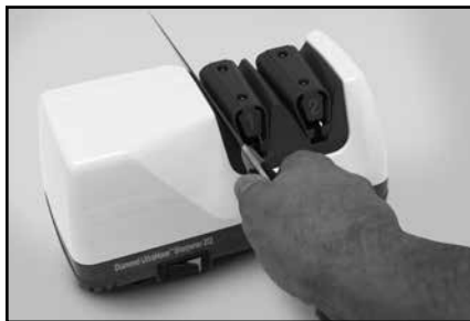
Afbeelding 3. Fase 1. Steek het lemmet in de sleuf tussen de precisiegeleiding en de veergeleidingen. Wissel enkele slijpbewegingen af in de linker- en rechtersleuf.
