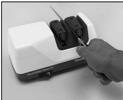
Afbeelding 6. Plaats het lemmet in de linkersleuf van Fase 2. Wissel enkele slijpbewegingen af in de linker- en rechtersleuf.
