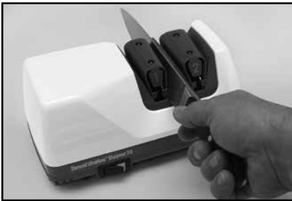
Afbeelding 4. Steek het lemmet in de rechtersleuf van Fase 1.
