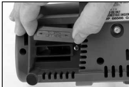
17. ábra. A fedél eltávolítása az élező alatt, hogy megtisztítsuk azt a keletkező fémportól (lásd a normal kezelés szakaszt)
