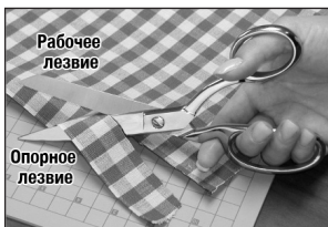
Рисунок 11: Типичная позиция рабочего и опорного лезвия для праворучных ножниц.
