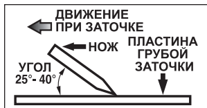
Рисунок 6: Предварительная заточка ножа пластиной грубой абразивности: правильное движение и угол.
