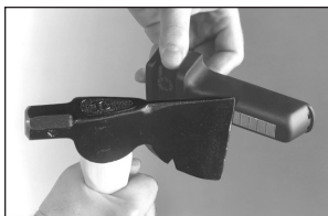
Рисунок 7: Заточка топора на пластине грубой абразивности.
