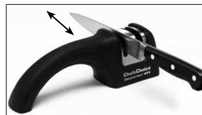
Abbildung 1. Messer in Stufe 1. Zum Schleifen mit mäßigem Druck nach unten hin- und herbewegen siehe Text .
