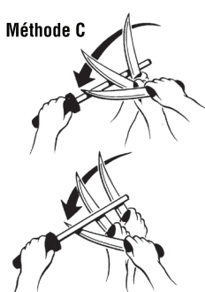
Méthode C – ATTENTION! Les mouvements effectués en direction la main immobile comportent un danger. Méthode réservée aux professionnels UNIQUEMENT.
