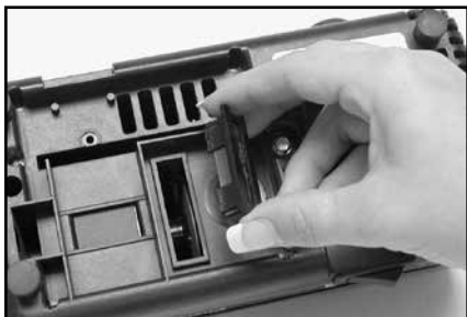
Bild 12. Ta bort luckan under botten för att rengöra metalldammen.
