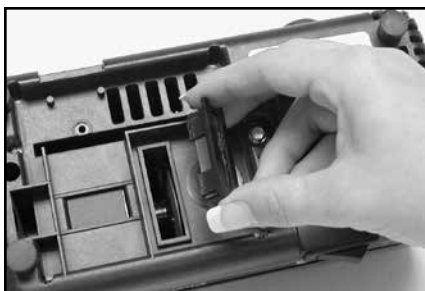
Figur 11. Fjerne deksel under slipemaskinen og fjerne metallstøv.
