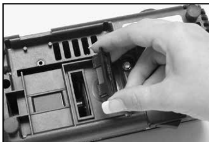
Abbildung 11. Abnehmen der Abdeckung am Unterboden, um den im Inneren angesammelten Metallstaub zu entfernen.
