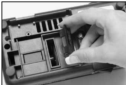
Obr. 10 - Otvor na čistenie
