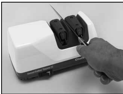
Малюнок 6. Лезо у лівому пазу Етапу 2. Чергуйте протягування через лівий та пази.
