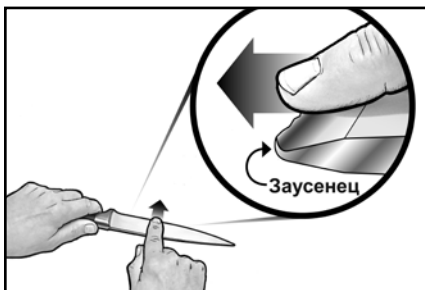
Рисунок 5. Добейтесь образования заметного заусенца вдоль всей кромки лезвия, перед тем как переходить к полировке в Устройстве 2. Чтобы обнаружить заусенец, проведите пальцем поперек кромки лезвия. Осторожно! См. инструкцию.
