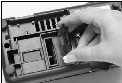
Fig. 10. Curatati particule de metal acumulate dedesubtul ascutitorului.
