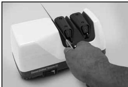
Fig. 3. Introducerea lamei in fanta dintre ghidaj si arcul elastometric. Se alterneaza tragerile individuale in fantele din stanga si dreapta.
