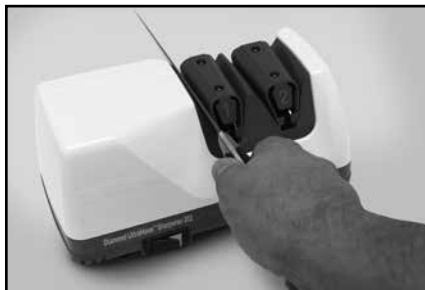
Joonis 3. Etapp 1. lõiketera on praos nurksuunaja ja elastse vedru vahel. Tehke vaheldumisi läbitõmbeid seadme vasaku ja parema prao vahel.
