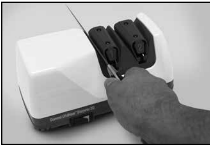
3. attēls. I pakāpe. Asmens ievietošana atverē starp vadotni un elastomēra atsperi. Velciet nazi pārmaiņus cauri kreisajai un labajai atverei
