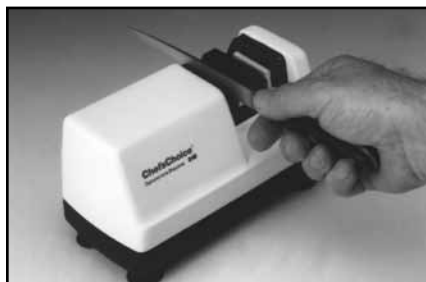
Fase 1. Per "Preparare" il coltello in Fase 1 ci vorranno da 15 a 20 tiri attraverso ogni scanalatura, alternando tra la scanalature sinistra e quella destra. Quando affilate questo coltello un'altra volta, ci vorranno meno tiri che in Fase 1. Applicare pressione leggera o moderata verso il basso.
