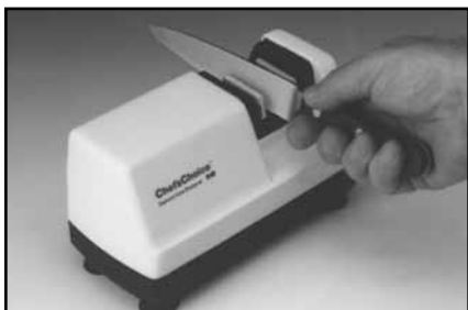
Fase 1. Per "Preparare" il coltello in Fase 1 ci vorranno da 15 a 20 tiri attraverso ogni scanalatura, alternando tra la scanalature sinistra e quella destra. Quando affilate questo coltello un'altra volta, ci vorranno meno tiri che in Fase 1. Applicare pressione leggera o moderata verso il basso.
