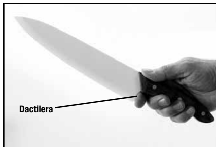
Figura 5. Si la hoja tiene una dactilera considerable, puede resultarle útil colocar un dedo detrás de esta, como aquí se muestra, cuando la esté afilando.
