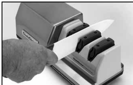
Figura 2. Bruñido de un cuchillo de cerámica en las dos ranuras de la Fase 2.
