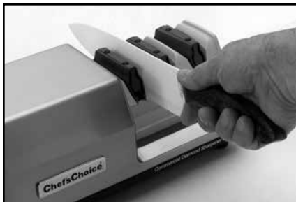
Figura 6. Introduzca el dedo índice en la dactilera, según se indica, al introducir el cuchillo en la ranura de afilado (véase la sugerencia 8).
