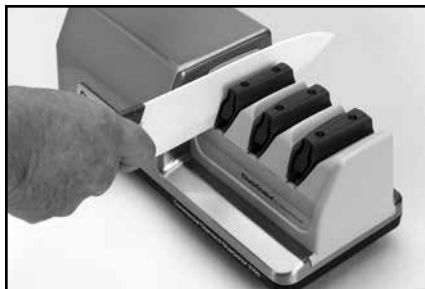
Figura 1. Afilado de un cuchillo de cerámica, primero en las dos ranuras de la Fase 1.
