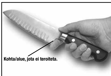
Kuva 11. Jos terässä on kohta/alue, jota ei pidä tai voi teroittaa, on hyvä asettaa etusormi teroitusesteeksi.
