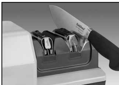
Figur 7. Bryning i steg 2 – växelvís drag i vänster skåra och höger skåra för att skapa den slutgiltiga fasytan. Knivseggen vilar lätt mot eggstopplattan.
