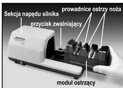
Rysunek 2: Moduł ostrzący jest wkładany po przewodnicach i wsuwany w kierunku obudowy silnika, po czym sprzęga się z napędem. W celu rozłączenia, wciśnij przycisk zwalnający i wysuń od silnika. Zobacz tekst.
