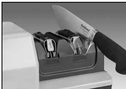
Abbildung 7: Schleifen in Stufe 2 - Der endgültige Schliff entsteht durch abwechselndes Ziehen durch den linken und rechten Schlitz. Die Schneide liegt leicht auf dem Schneidenanschlag auf.
