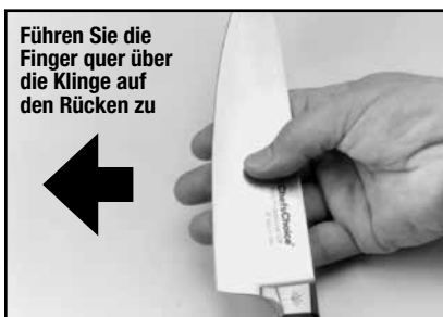
Abbildung 5: Sie fühlen den Grat, wenn Sie die Finger quer über die Klinge auf den Rücken zu führen. Vorsicht! Siehe Text.
