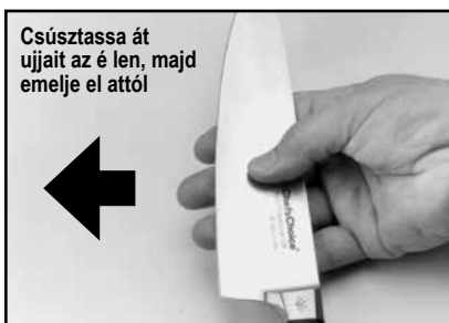
5. ábra A sorját úgy tapinthatja ki, hogy ujjait a kés lapjára helyezi, majd a késlappal párhuzamosan csúsztassa át ujjait az élen, majd emelje el attól. Figyelmeztetés! Olvassa el a leírást.
