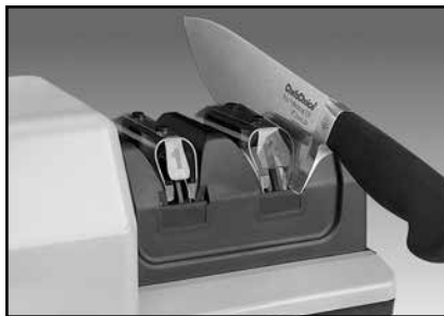
7. ábra Fenés a második fokozatban – Váltakozó húzások a bal és jobb nyílásban a végső élprofil létrehozására. A kés éle érintkezik az ütközőlemezzel.
