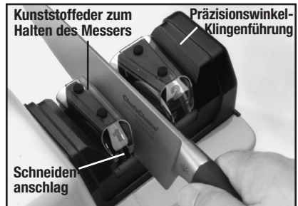
Abbildung 3: Das Messer wird zwischen der Klingenführung und der Kunststofffeder eingeführt, bis die Schneide leicht auf dem Scheidenanschlag aufliegt.
