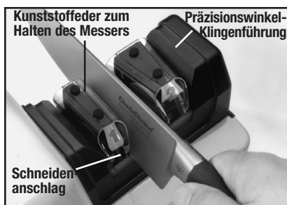
Abbildung 6: Schärfen in Stufe 1: Das Messer wird zwischen der Klingenföhrung und der Kunststoffeder eingeföhrt, bis die Schneide leicht auf dem Schneidenanschlag aufliegt.
