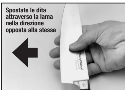
Figura 5: la bava può essere rilevata facendo scorrere le dita attraverso la lama nella direzione opposta alla stessa. Fate molta attenzione e leggete le istruzioni in merito.
