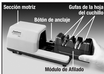
Figura 2. El Módulo de Afilado se inserta en los railes y se desliza hacia la sección motriz con objeto de ajustarse con el motor. Para retirarlo, presionar sobre el botón de anclaje y deslizar el conjunto en sentido opuesto a la sección motriz. Ver el texto.
