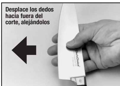
Figura 5. Le rebaba se puede apreciar deslizando los dedos sore la superficie y alejándolos del corte. ¡Cuidado! Ver el texto.
