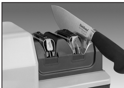
Figura 7: molatura nella fase 2. Effettuate passaggi alternati a destra e a sinistra per creare la molatura finale. La lama del coltello poggia leggermente sulla piastra di arresto.
