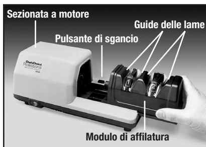
Figura 2: il modulo di affilatura viene inserito sulle rotaie e fatto scorrere in avanti verso la sezione a motore per attivare l'azionamento a motore. Per sganciare, premete sul pulsante di sgancio e far scorrere nella direzione opposta. Fate riferimento alle istruzioni in merito.
