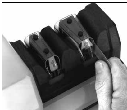
Kuva 9. Vaiheen 2 hoonauslaikkojen puhdistus.
