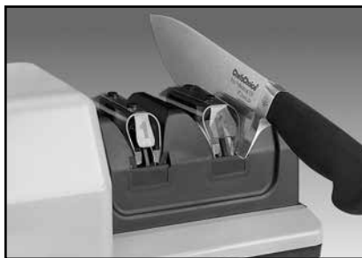
Obrázek 7. Leštění ve stupni 2 - vkládání nože mezi šikmou plochu přístroje a plastovou vodící pružinu, ostří leží na přední podpůrné desce.
