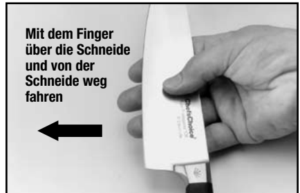
Abb. 5. Grat lässt sich feststellen, indem mit dem Finger über die Schneide und von der Schneide weg gefahren wird. Vorsicht! Siehe Text.
