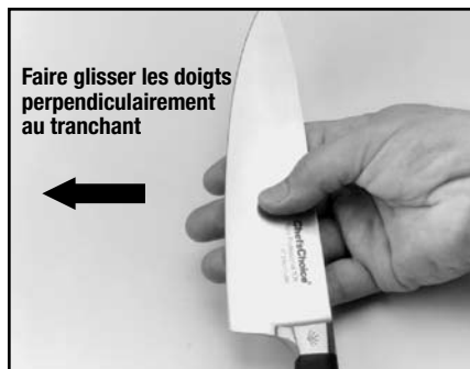
Figure 5. La bavure peut être décelée en faisant glisser les doigts perpendiculairement au tranchant en les éloignant du tranchant. Faites attention! Voir le texte.
