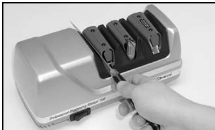
Afbeelding 3. Fase 1. Het lemmet in de sleuf tussen de geleider en elastomerische veer inbrengen. Afwisselend het lemmet door de rechter- en linkersleuven halen.
