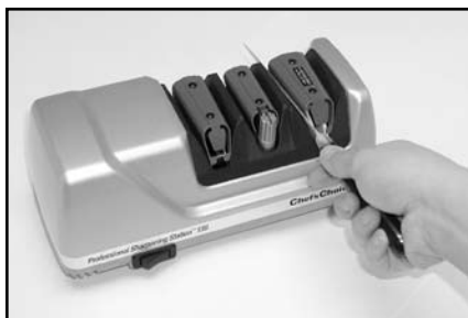
Afbeelding 6. Het lemmet in de linkersleuf van Fase 3 steken. Afwisselend door de linker- en rechtersleuf heen halen.
