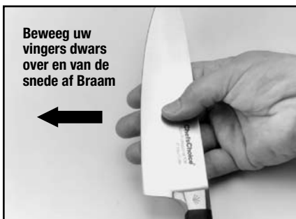
Afbeelding 5. De braam kan waargenomen worden door de vingers dwars over en weg van de snede te laten glijden. Let op! Zie tekst.
