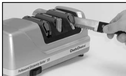
Figure 10. Aiguiser les lames crantées uniquement dans la phase 3. (Voir les instructions).
