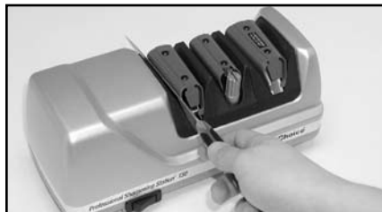
Figura 3. Fase 1. Inserimento della lama nella fessura fra la guida e l'anello elastomerico. Alternare trazioni individuali nelle fessure destra e sinistra.
