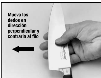
Figura 5. La rebaba se puede detectar deslizando los dedos en dirección perpendicular y contraria al filo. ¡Precaución! Lea el texto.
