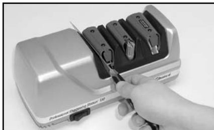
Figure 3. Phase 1. Insérez la lame dans la fente entre le guide et le ressort en élastomère. Effectuez des passages alternés dans les fentes droite et gauche.
