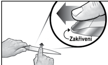
Obrázek 4. Kontrola přítomnosti zakřivení
