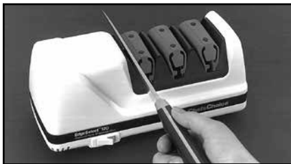
Obr. 3: Stupeň 1 Vloženie čepele do štrbiny medzi vodiacim prvkom a pružnou lamelou. Striedajte ľavú a pravú štrbinu.
