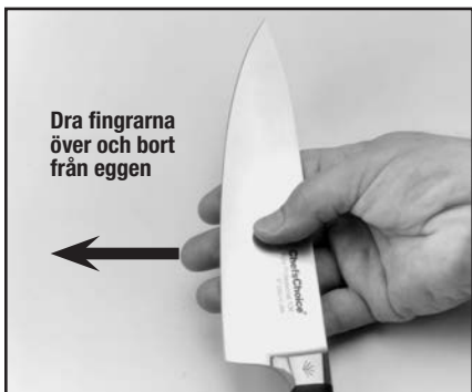
Figur 7. Detektera slipgraden genom att dra fingrarna över och bort från eggens. lakttia försiktighet! Se texten.
