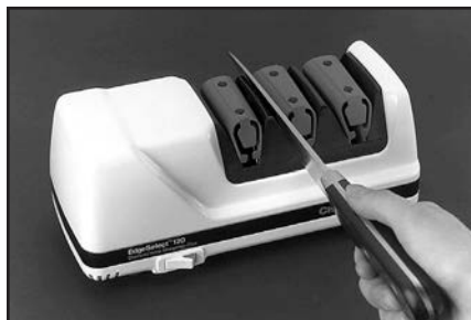
Figur 4. Införing av bladet i vänster skåra i steg 2.
