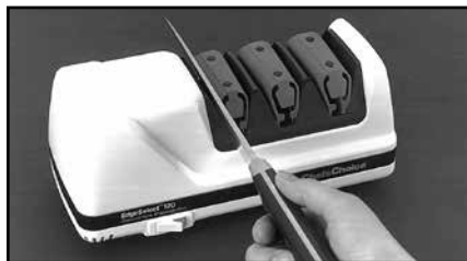
Figura 3. Etapa 1. Introducerea lamei in fanta dintre ghidaj si arcul elastometric. Trageri alternative, in fantele din stanga si dreapta.
