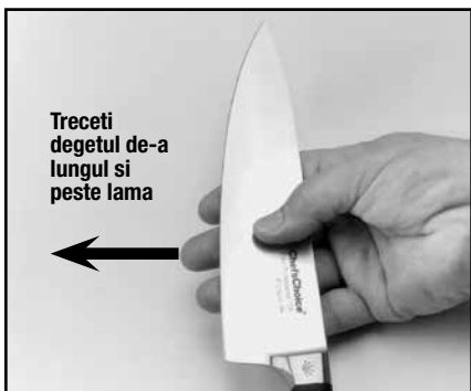
Figura 7. Bavura poate fi detectata prin trecerea degetului de-a lungul si peste lama. Atentie!
