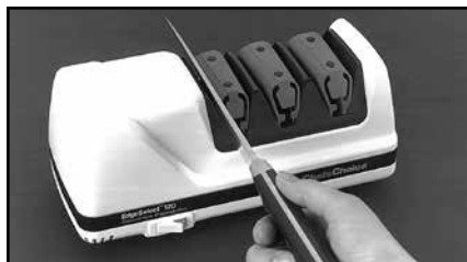
Joonis 3. Etapp 1. Sisestate tera prakku suunaja ja elastikust vedru vahele. Vaheldumisi vasak ja parem praugu.
