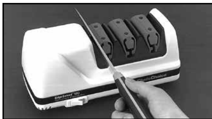
3. attēls. I pakāpe. Asmens ievietošana atverē starp vadotni un elastomēra atsperi. Velciet nazi pārmaiņus cauri kreisajai un labajai atverei
