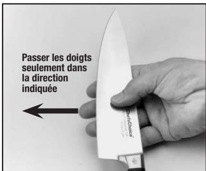
Figure 7. Il est possible de déceler la présence d'une bavure en passant les doigts en travers de la lame. Faire très attention. Suivre les directives ci-dessous.
