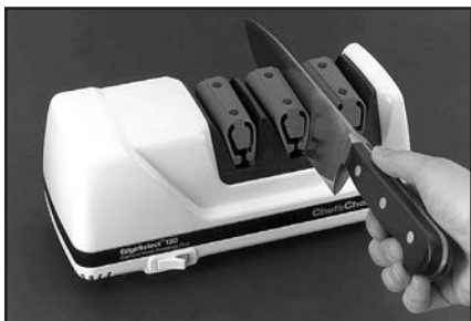
Figure 5. Lame rentrée dans la fente droite de la 2e cellule.
