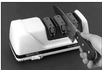
Figura 5. Insertando la hoja en la ranura derecha de la Fase 2.
