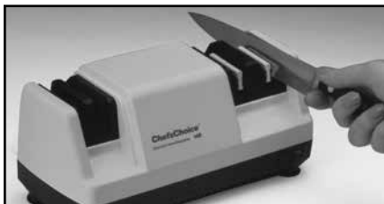
Etape 3— Huit (8) passages rapides par chaque fente, (fente d'AFFILAGE gauche et droite). Alternez chaque passage.
