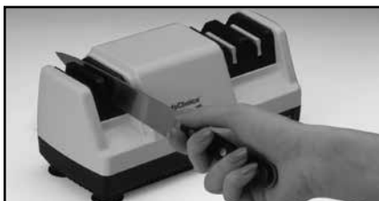
Fase 1 — Tre o più passaggi lenti su ciascuna fessura (sinistra e destra nelle fessure di PRE-AFFILATURA). Alternando ciascun passaggio.
