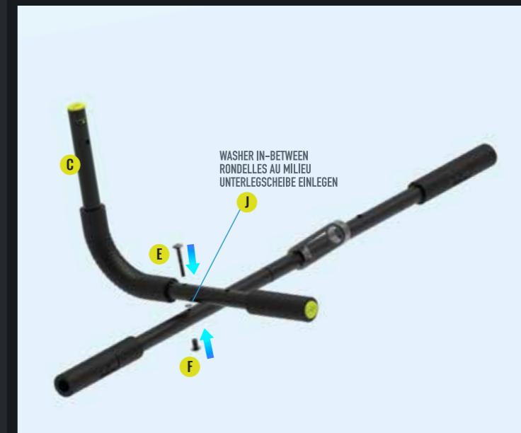
**2** **EN** Place an L shape bar over the back pipe's screw hole, with 1 washer in-between. **FR** Placez une barre en forme de L au-dessus du trou à vis du tube arrière, avec 1 rondelle entre les deux. **DE** Eine L-Stange über die Bohrung im hinteren Rohr halten, dabei eine Unterlegscheibe einlegen. Eine Schraube einschieben und mit der Schraubkappe an der anderen Seite sichern.
