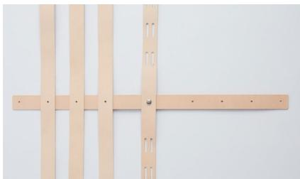
25. Insérez l'anneau en D (K) dans la sangle verticale avec les poinçons (D) et repliez l'extrémité pour aligner le trou de perforation avec la sangle horizontale (F) la plus proche. (Image 18)
