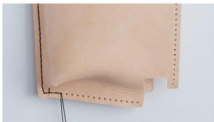
19. Cousez entre le côté inférieur/droit du devant du corps (C), puis sur le côté droit. Selle recoudre. Terminez par un point de verrouillage des bords. Faites un point arrière de 2 à 3 points pour sécuriser. (Image 14) **Voir Améliorez vos compétences à partir de la page 12 pour obtenir des instructions détaillées sur la façon de faire du point arrière.**
