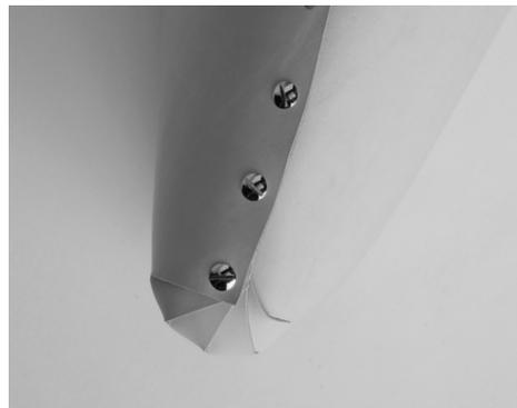
. Pour le quatrième jeu de trous (à partir du bas), nous attacherons le support (D). Alignez le support (D) sur le quatrième ensemble de trous de sorte que le côté chair rencontre le côté poil du corps du sac (A). Insérez une vis à dos ouvert négative de 1/8" (C) à partir de l'intérieur du corps du sac (A). Il devrait passer par trois morceaux de cuir. Fermez à l'aide d'une vis à dos ouvert positive (C) pour fixer solidement le support (D). (Images 19-20)
