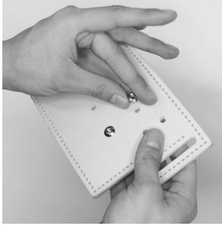
16. Opcional: Utilice el pegamento Loctite® Threadlocker recomendado (se encuentra en casi todas las ferreterías) para fijar los tornillos de remache (J). Coloque una pequeña cantidad en la tapa del tornillo (J) y conéctelo al poste del tornillo con un destornillador plano. Complete esto para ambos orificios fijando un lado de la funda de la linterna (G). (Figuras 21 y 22)
