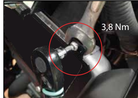
Imagen No. 5 - Ajuste platina C. a platinas A. y B. ajuste 3,8 Nm.
