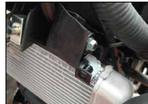
Imagen No. 3 - Ubicación platina A. en punto superior base radiador, ajuste 10 Nm.
