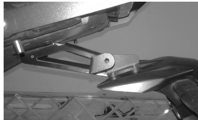
**1-** Soltar los tornillos (6mm) que se encuentran sujetando el porta placas y direccionales, en la parte trasera de la moto. Luego de soltar los tornillos, ubicar allí la pieza 1 y ponerla haciendo uso de los tornillos suministrados (A) asegurándose de poner los bujes (B) de manera que queden entre la platina y la motocicleta.
