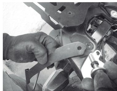
**3-** Soltar las agarraderas de la moto y ubicar en el agujero trasero un buje (F). Poner la platina Agarradera (2), luego el buje (F) y proceder a poner la agarradera original de la moto, fijandola con el tornillo suministrado (D) haciendo uso de la arandela original de la moto.
