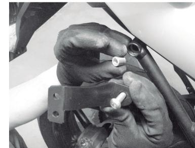
**4-** Soltar el tornillo original que sostiene la cercha (chasis) a la cola de la moto, poner la platina Cercha (1) asegurándose de poner el buje (H) de tal manera que quede entre la platina y la moto. Luego asegurar la platina usando el tornillo suministrado (B).
