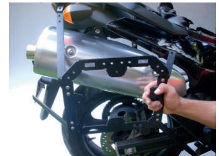
Ensamble de platina placa (7) Con tornillos suministrados (D), arandelas (A), tuercas (C)
